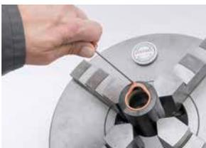
7. Die Gasdruckfeder am Gehäuse handfest in einem Backenfutter einspannen. Beim Einspannen darauf achten, dass die Gasdruckfeder durch den Spanndruck nicht beschädigt oder deformiert wird. Den Abstreifer mittels Schraubendreher oder anderem geeigneten Werkzeug aus dem Gehäuse entfernen und entsorgen.
