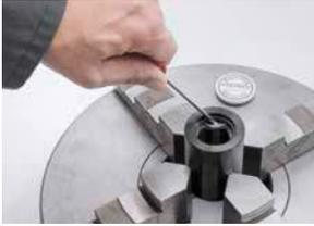
10. Dichtung entfernen.
