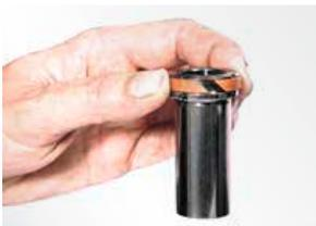
6. Das Kolbenführungsband in die dafür vorgesehene Nut am Kolben einclippen.
