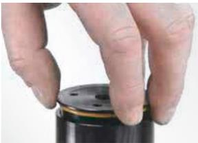
16. Boden in das Gehäuse einsetzen und von Hand andrehen, bis der Widerstand des O-Rings spürbar wird.
