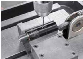
2. Bohren Sie das Gehäuse der Gasdruckfeder zum Entlüften mittig mit einem Spiralbohrer (Durchmesser des Bohrers ca. 4 mm) auf.
