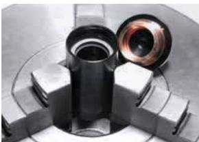
8. Gasdruckfeder aus dem Backenfutter ausspannen, DS-Werkzeug von der DS-Aufnahme entfernen.
