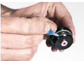
14. Gewinde des Bodens mit dem beiliegenden Schraubensicherungslack sparsam benetzen.
