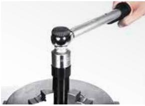
16. Den Boden mittels Werkzeug (⇒ RA, 4.7 Reparatur- und Werkzeugsätze) und einem Drehmomentschlüssel anziehen (⇒ RA, 4.8 Einschraubmomente).
