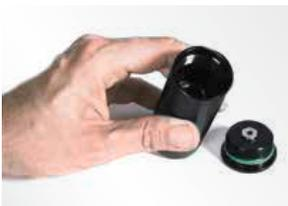
4. Gasdruckfeder aus dem Backenfutter ausspannen, Werkzeug vom Boden entfernen.
