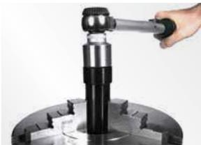
3. Bodenwerkzeug mittels Ring- oder Drehmomentschlüssel entgegen dem Uhrzeigersinn drehen, bis das Bodenwerkzeug mitsamt dem Boden abgenommen werden kann.
