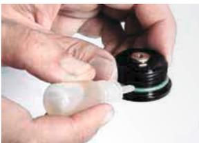
11. Den O-Ring nach dem Einbringen mit etwas Öl benetzen. Das Gewinde ölfrei halten.
