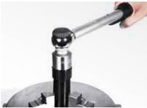
17. Den Boden mittels Werkzeug und einem Drehmomentschlüssel anziehen (⇒ RA, 4.8 Einschraubmomente).
