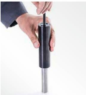
1. Zum Entlüften die Gasdruckfeder in vertikaler Lage mit dem Kolben nach unten halten. Die Entladeschraube (⇒ RA, 4.7 Reparatur- und Werkzeugsätze) vorsichtig eindrehen, bis das Ausströmen des Stickstoffs zu hören ist.
