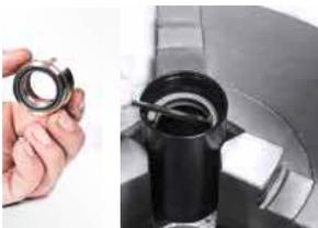
9. Die ausgebaute DS-Aufnahme komplett entsorgen. Anschließend die Gasdichtung mittels Schraubendreher oder anderem geeigneten Werkzeug aus dem Gehäuse ausbauen und ebenfalls entsorgen.
