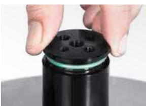
14. Boden in das Gehäuse einsetzen und von Hand andrehen, bis der Widerstand des O-Rings spürbar wird.
