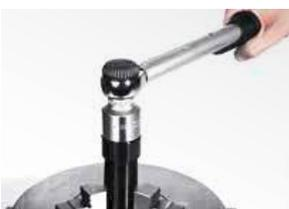
16. Den Boden mittels Werkzeug und einem Drehmomentschlüssel anziehen (⇒ RA, 4.8 Einschraubmomente).
