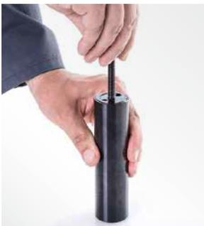
2. Durch komplettes Eindrücken des Kolbens die Entlüftung der Gasdruckfeder von Hand überprüfen. Ist dies nicht möglich, Entladeschraube erneut eindrehen.
