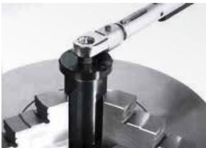
7. Gasdruckfedergehäuse mit DS-Aufnahme (⇒ RA, 4.7 Reparatur- und Werkzeugsätze) im Backenfutter handfest einspannen. DS-Werkzeug aufsetzen und mittels Ring- oder Drehmomentschlüssel entgegen dem Uhrzeigersinn drehen, bis die DS-Aufnahme abgenommen werden kann.
