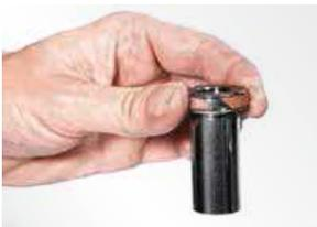
6. Das Kolbenführungsband in die dafür vorgesehene Nut am Kolben einklippen.
