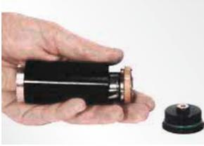
5. Kolben von Hand in Richtung Bodengewinde schieben, bis der Kolben frei ist und entnommen werden kann.
