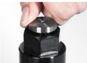
15. Das passende Werkzeug auf den Boden aufsetzen und mit der zugehörigen Zylinderschraube fixieren. (⇒ RA, 4.7 Reparatur- und Werkzeugsätze).
