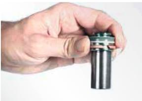
6. Gasdichtung und Führungsband auf korrekten Sitz überprüfen.
