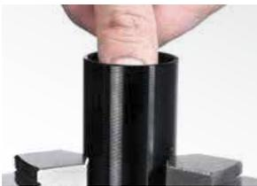
11. Das Gehäuse in einem Backenfutter handfest einspannen. Beim Einspannen darauf achten, dass die Gasdruckfeder durch den Spanndruck nicht beschädigt oder deformiert wird. Nach dem Einführen des Kolbens in das Gehäuse den Kolben von Hand eindrücken.
