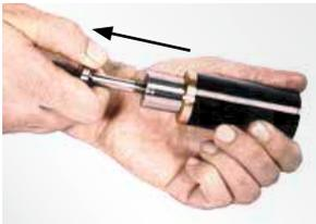
17. Die Kolbenstange mittels der Entladeschraube nach vorne gegen den Festanschlag im Gehäuse ziehen.
