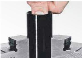
8. Das Gehäuse in einem Backenfutter handfest einspannen. Beim Einspannen darauf achten, dass die Gasdruckfeder durch den Spanndruck nicht beschädigt oder deformiert wird. Danach den Kolben mit Kraft einpressen.
