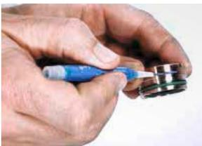
4. Nun bei allen Typen das Gewinde der DS-Aufnahme mit dem beiliegenden Schraubensicherungslack sparsam benetzen.
