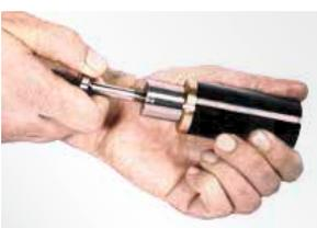
17. Den Kolben mittels der Entladeschraube nach vorne gegen den Festanschlag im Gehäuse ziehen.
