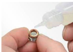
2. Den Kupferferring der Berstschraube mit Öl benetzen.
