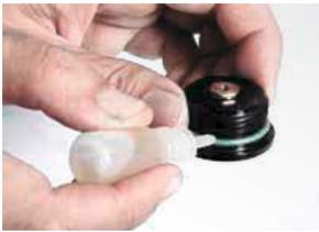
9. Den O-Ring vor dem Einschrauben mit etwas Öl benetzen.
