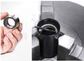
7. Gasdruckfedergehäuse mit DS-Aufnahme (⇒ RA, 4.7 Reparatur- und Werkzeugsätze) nach oben im Backenfutter handfest einspannen. DS-Werkzeug aufsetzen und mittels Ring- oder Drehmomentschlüssel entgegen dem Uhrzeigersinn drehen, bis die DS-Aufnahme abgenommen werden kann.
