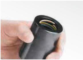
4. Anschließend das Führungsband in die mittlere Nut des Gehäuses einklippen.
