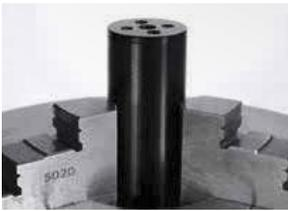
1. Die Gasdruckfeder am Gehäuse in einem Backenfutter handfest einspannen. Beim Einspannen darauf achten, dass die Gasdruckfeder durch den Spanndruck nicht beschädigt oder deformiert wird.
