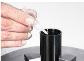
13. Die erforderliche Ölmenge aus dem Kunststoff-Fläschchen in den Innenraum der Gasdruckfeder füllen (⇒ RA, 4.9 Fülltabellen Öl).
