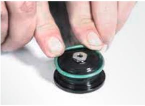
10. Den beiliegenden O-Ring in die gesäuberte Nut des Bodens einbringen und den korrekten Sitz prüfen.
