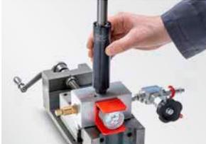
1. Fülleinheit (Artikelnummer SZ80855-1) in einen Schraubstock einspannen.
