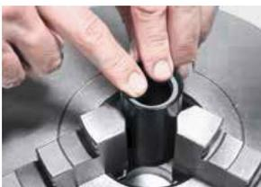
3. Die Gasdichtung auf korrekten Sitz überprüfen.
