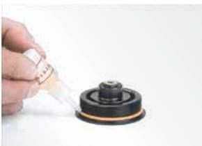
10. Den O-Ring nach dem Einbau mit etwas Öl benetzen. Das Gewinde ölfrei halten!
