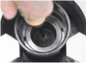
13. Den Kolben mittels eines Schraubendrehers in der Kolbenbohrung gegen den Festanschlag drücken.
