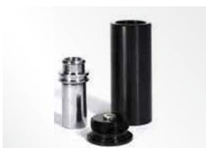
9. O-Ring vom abgeschraubten Boden entfernen. Kolbenführungsband vom Kolben entfernen. Teile gründlich säubern und nochmals auf Beschädigungen überprüfen.
