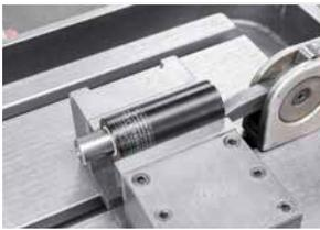
1. Spannen Sie die Gasdruckfeder in einem Backenfutter ein.
