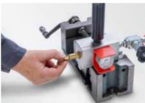
5. Eingangsventil der Fülleinheit langsam öffnen, bis der vorgegebene Fülldruck erreicht ist. Dieses Ventil dann schließen. Vor dem Abschrauben der Gasdruckfeder den Druck aus der Fülleinheit über das seitliche Entlüftungsventil ablassen!
