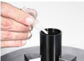
14. Die erforderliche Ölmenge des Kunststoff-Fläschchens in den Innenraum der Gasdruckfeder füllen (⇒ RA, 4.9 Fülltabellen Öl).
