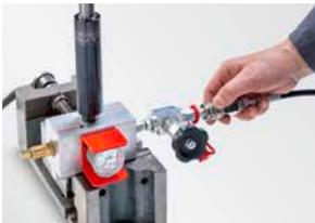
3. Ladeschlauch an Fülleinheit anschließen. Eingangsventil der Fülleinheit muss geschlossen sein!
