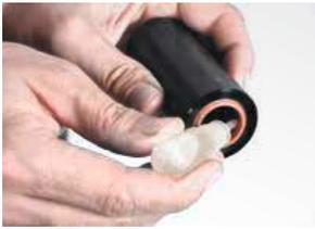
7. Etwas Öl aus dem beiliegenden Kunststoff-Fläschchen in den oberen Führungsbereich des Gehäuses geben.
