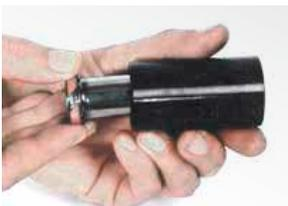
7. Die Gasdichtung sowie die Zylinderbohrung leicht mit Öl benetzen. Den vormontierten Kolben vorsichtig in das Gehäuse einführen und mit Kraft einpressen.
