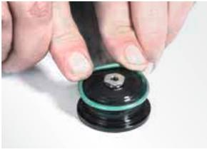
8. Den beiliegenden O-Ring in die gesäuberte Nut des Bodens einpassen und den korrekten Sitz überprüfen.
