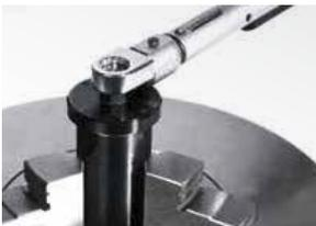
5. DS-Aufnahme mittels DS-Werkzeug und einem Drehmomentschlüssel anziehen (⇒ RA, 4.8 *Einschraubmomente*). Überflüssige Gewindegewandung ist sofort zu entfernen!
