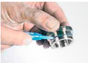
4. Das Gewinde der DS-Aufnahme mit dem beiliegenden Schraubensicherungslack sparsam benetzen.
