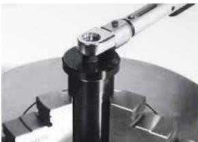
5. Die DS-Aufnahme mittels Werkzeug (⇒ RA, 4.7 Reparatur- und Werkzeugsätze) und einem Drehmomentschlüssel anziehen (⇒ RA, 4.8 Einschraubmomente).
