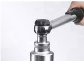
18. Den Boden mittels Werkzeug und einem Drehmomentschlüssel anziehen (⇒ RA, 4.8 Einschraubmomente).
