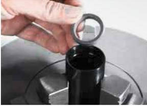
2. Die Gasdruckfeder am Gehäuse handfest in einem Backenfutter einspannen. Beim Einspannen darauf achten, dass die Gasdruckfeder durch den Spanndruck nicht beschädigt oder deformiert wird.
