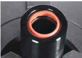
4. Beim Einbau des Führungsbandes und des Abstreifers ist darauf zu achten, dass diese in den dafür vorgesehenen Nuten korrekt eingesetzt sind.
