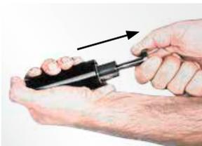
18. Den Kolben mittels der Entladeschraube nach vorne gegen den Festanschlag im Gehäuse ziehen.
