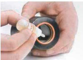
8. Etwas Öl aus dem beiliegenden Fläschchen in den oberen Führungsbereich des Gehäuses geben. Wenn das Gehäuse kopfüber gestellt wird, verteilt sich das Öl gleichmäßig. Das Gewinde am Gehäuse ölfrei halten.
