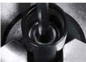
9. Den Kolben mittels eines Schraubendrehers in der Kolbenbohrung gegen den Festanschlag drücken.
