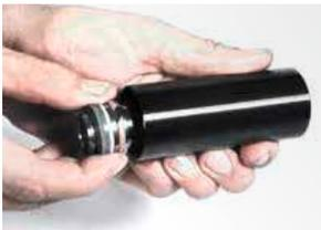
10. Die Gasdichtung mit Öl benetzen. Den vormontierten Kolben vorsichtig in das Gehäuse einführen und mit Kraft einpressen. Beim Überfahren der Gasdichtung über das Gewinde ist darauf zu achten, dass die Gasdichtung nicht beschädigt wird.
