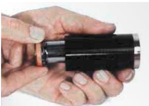
7. Das Gehäuse in einem Backenfutter handfest einspannen. Beim Einspannen darauf achten, dass die Gasdruckfeder durch den Spanndruck nicht beschädigt oder deformiert wird. Nach dem Einführen des Kolbens in das Gehäuse den Kolben von Hand eindrücken.
