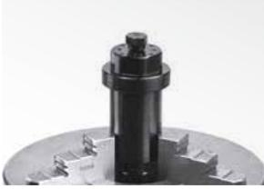
2. Entsprechendes Bodenwerkzeug (⇒ RA, 4.7 Reparatur- und Werkzeugsätze) aufsetzen und mit der zugehörigen Zylinderschraube fixieren.
