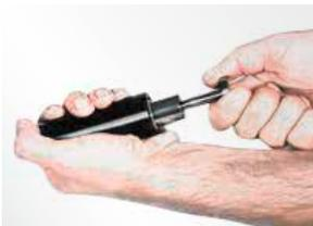
19. Den Kolben mittels der Entladeschraube oder einer geeigneten Zylinderschraube nach vorne gegen den Festanschlag im Gehäuse ziehen.
