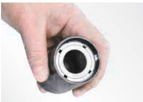
11. Den vormontierten Kolben vorsichtig in das Gehäuse einführen und mit Kraft einpressen. Dabei beachten, dass das Führungsband nicht durch das Gewinde im Gehäuse beschädigt oder verschoben wird.
