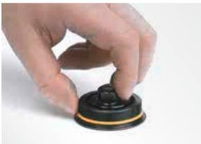
9. Den beiliegenden O-Ring in die gesäuberte Nut des Bodens einpassen und den korrekten Sitz überprüfen.
