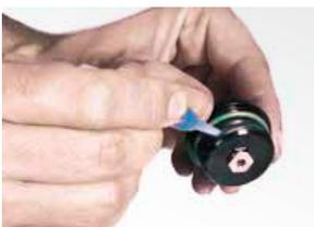
13. Gewinde des Bodens mit dem beiliegenden Schraubensicherungslack sparsam benetzen.
