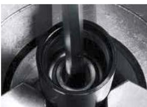
12. Den Kolben mittels eines Schraubendrehers in der Kolbenbohrung gegen den Festanschlag drücken.
