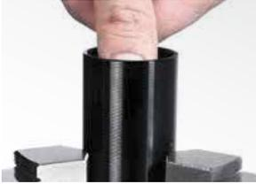
12. Das Gehäuse in einem Backenfutter handfest einspannen. Beim Einspannen darauf achten, dass die Gasdruckfeder durch den Spanndruck nicht beschädigt oder deformiert wird. Nach dem Einführen des Kolbens in das Gehäuse den Kolben von Hand eindrücken.
