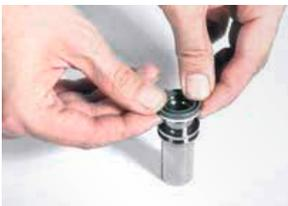
5. Die Gasdichtung mit dem Backring nach unten über die Kolbenunterseite bis zum Anschlag aufschieben. Das zweite Führungsband in die dafür vorgesehene Nut am Kolben einlegen.
