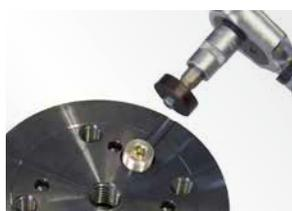
3. Beim Einbau mit dem Sechskant des Werkzeugeinsatzes nicht die Oberfläche der Berstscheibe berühren.
