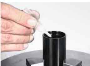
12. Die erforderliche Ölmenge aus dem Kunststoff-Fläschchen in den Innenraum der Gasdruckfeder füllen (⇒ RA, 4.9 Fülltabellen Öl).
