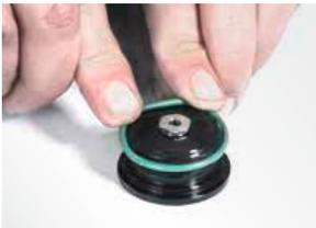
10. Den beiliegenden O-Ring in die gesäuberte Nut des Bodens einpassen und den korrekten Sitz prüfen.
