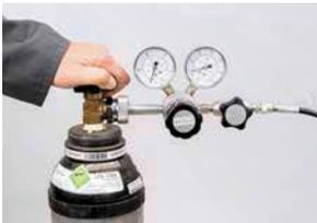
4. Stickstoffflasche vorsichtig aufdrehen. Auf Leckagen achten. Am Druckminderer den Befülldruck der Gasdruckfedern einstellen.
