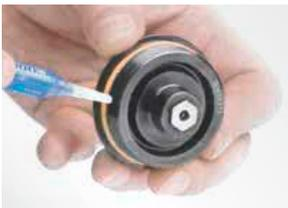
15. Gewinde des Bodens mit dem beiliegenden Schraubensicherungslack sparsam benetzen.
