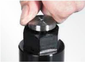
16. Das passende Werkzeug auf den Boden aufsetzen und mit der zugehörigen Zylinderschraube fixieren (⇒ RA, 4.7 Reparatur- und Werkzeugsätze).
