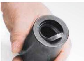
2. Zuerst alle Nuten des Gehäuses leicht mit Öl benetzen. Die graue Gasdichtung in die unterste Nut im Gehäuse einsetzen. Die V-Nut der Gasdichtung muss nach unten zeigen.
