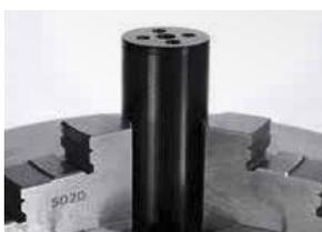
1. Die Gasdruckfeder am Gehäuse in einem Backenfutter handfest einspannen. Beim Einspannen darauf achten, dass die Gasdruckfeder durch den Spanndruck nicht beschädigt oder deformiert wird.
