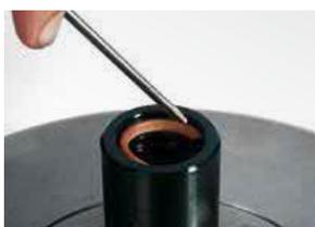
8. Das Führungsband mittels Schraubendreher oder anderem geeigneten Werkzeug aus dem Gehäuse entfernen und entsorgen.
