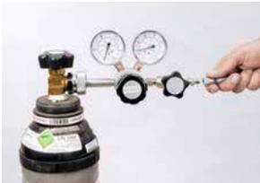
2. Ladeschlauch an Druckminderer der Stickstoffflasche anschließen.
