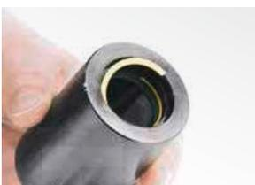
3. Den geschlitzten Backring so halten, dass die Anspritzpunkte nach oben zeigen. Den Backring mit einem Ende beginnend auf der Gasdichtung einlegen. Die Enden des eingelegten Backrings müssen bündig schließen und dürfen sich nicht überlappen.
