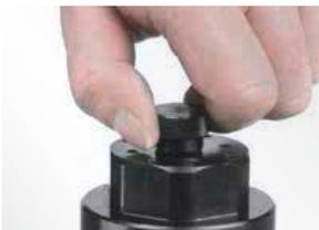
17. Das passende Werkzeug auf den Boden aufsetzen und mit der zugehörigen Zylinderschraube fixieren (⇒ RA, 4.7 Reparatur- und Werkzeugsätze).
