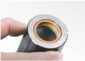
6. Beim Einbau des Führungsbandes, der Dichtung und des Abstreifers ist darauf zu achten, dass diese in die dafür vorgesehenen Nuten korrekt eingesetzt sind.
