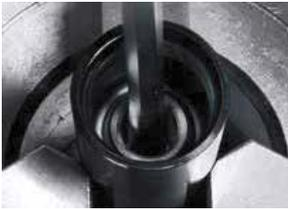
9. Den Kolben mittels eines Schraubendrehers in der Kolbenbohrung gegen den Festanschlag drücken.
